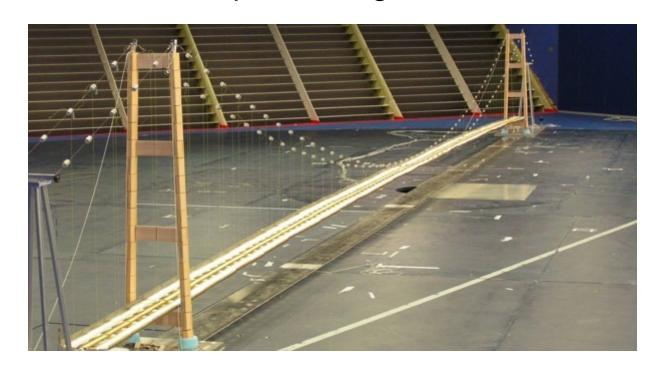
Modelli completi per la verifica globale del comportamento aerodinamico
