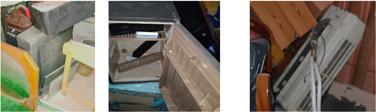
Foto 1 Alcune delle tipologie di RAEE rinvenute all'interno dell'edificio; da sinistra una TV a tubo catodico, un frigorifero e una unità interna di un condizionatore
