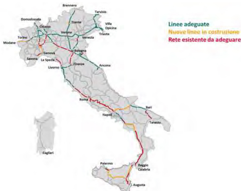
Figura – Linee adeguate e da adeguare sulla rete centrale merci in relazione allo standard di trasporto combinato PC80
