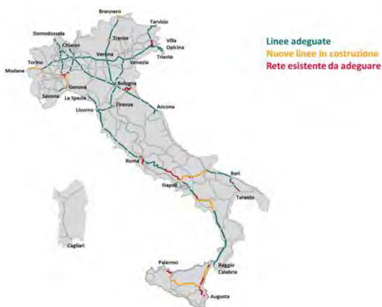
Figura – Linee adeguate e da adeguare sulla rete centrale merci in relazione allo standard di carico assiale D4
