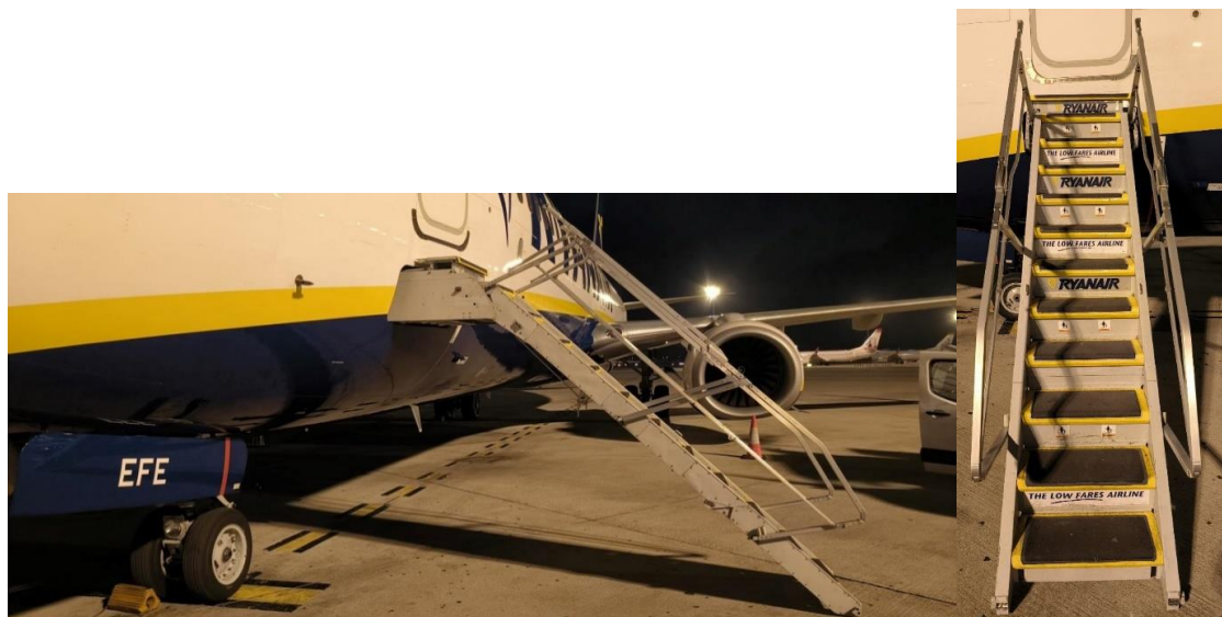
Viste laterale e frontale della scala integrata del B737.
