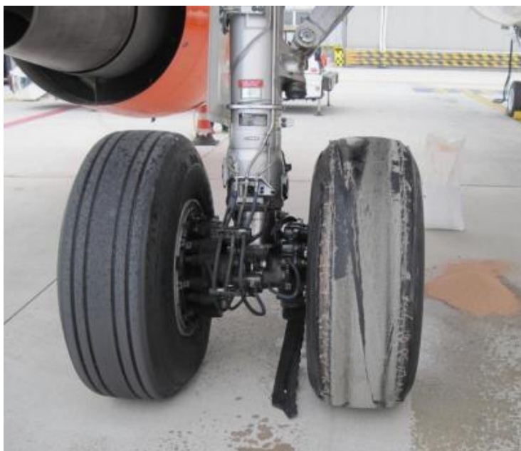
Condizioni dello pneumatico dopo l'atterraggio.
