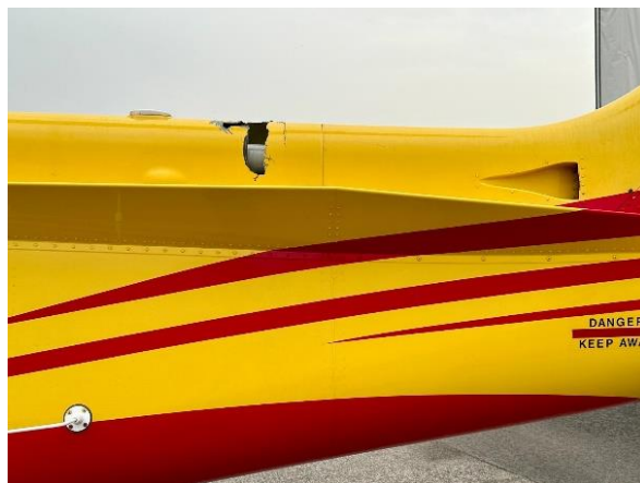
Danneggiamento dell'AW139 marche I-RJAH sulla cappottatura di protezione dell'albero del rotore di coda.
