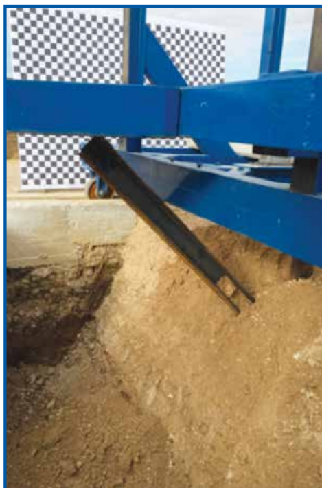
■ Prove dinamiche per la verifica interazione palo-terreno in condizioni diverse di installazione
