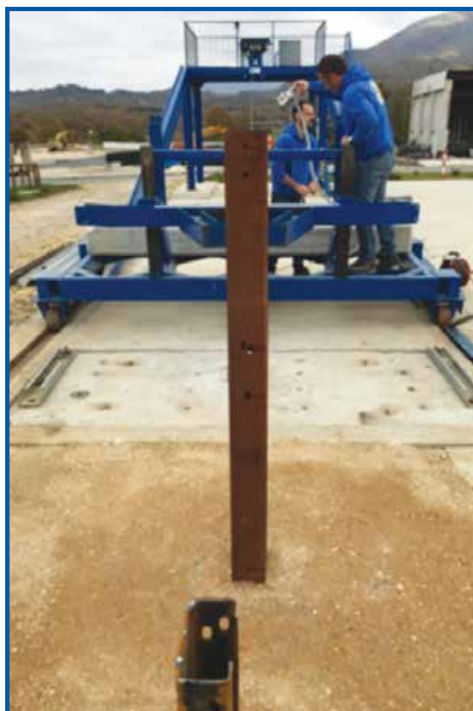
■ Prove dinamiche per la verifica interazione palo-terreno in condizioni diverse di installazione
