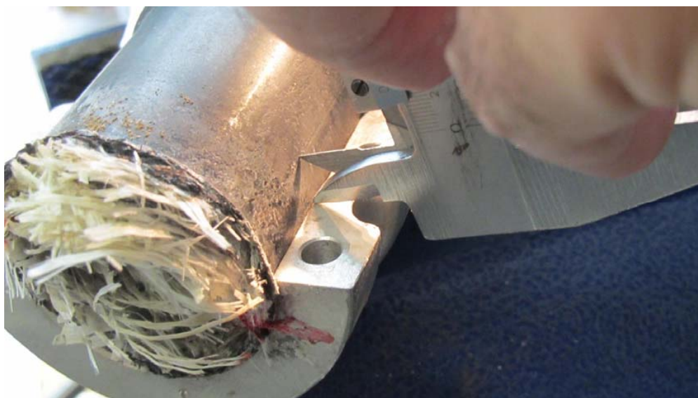
OK-LAU: controllo passo dell'elica effettuato nei laboratori dell'ANSV.
