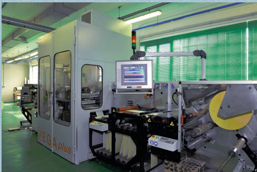
Stabilimento OCV e Produzioni Tradizionali Fustellatrice per la produzione di bollini farmaceutici - PRATI VEGA PLUS
