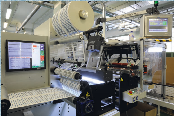
Stabilimento OCV - Produzione tradizionale Fustellatrice Prati deca plus 1f 450
