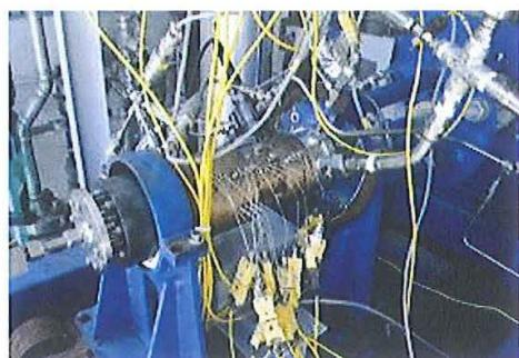
Nel corso del 2014, è stata completata la *review* inerente la progettazione di dettaglio del "Dimostratore di motore LO<sub>x</sub>/CH<sub>4</sub>", utilizzante ossigeno e metano liquidi, e quindi è iniziata la fase realizzativa. Rriguardo all'impianto di test a terra, da realizzare
