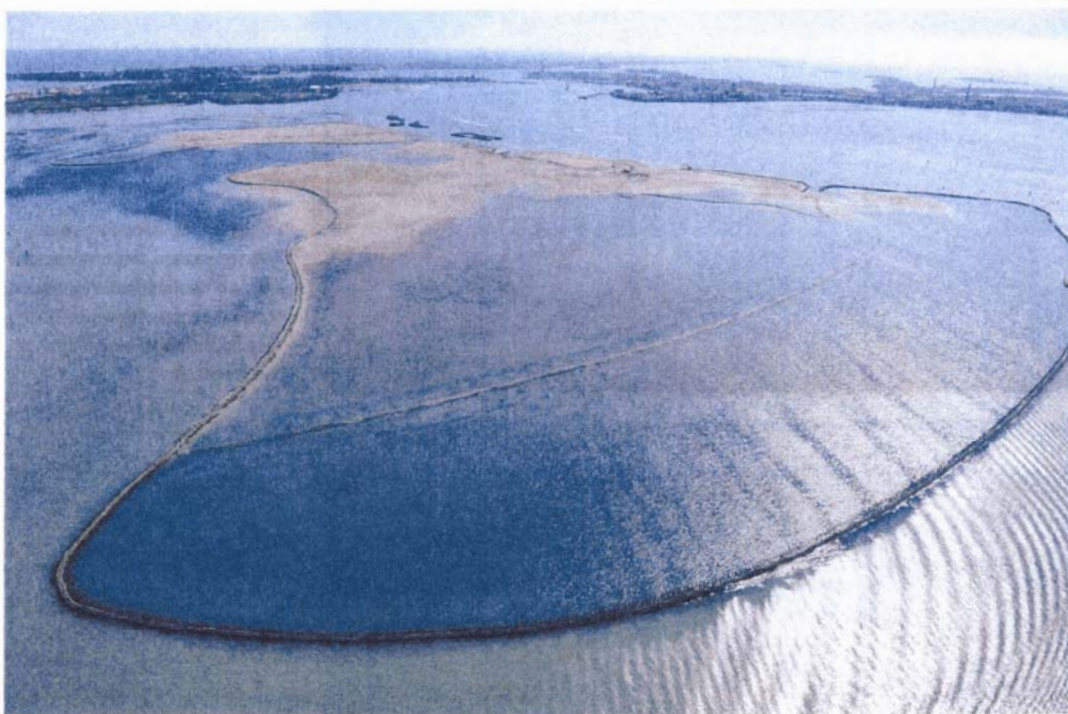
In queste foto, le diverse tipologie di conterminazione delle barene con burghie di vario tipo, l'opera soffolta a protezione del moto ondoso realizzata sempre in burghie e materassi
