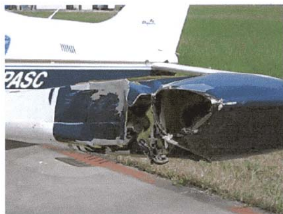
Danni riportati dall'aeromobile PA-28 marche I-PASC a seguito della collisione con un mezzo push back .
