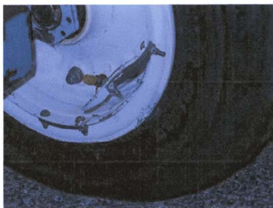
Danni al carrello anteriore di un CRJ 1000 durante la movimentazione in push back .
