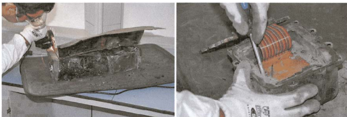
AB412 marche EC-JRY: a sinistra, apertura (FDR/CVR); a destra, rimozione memoria solida (FDR).
