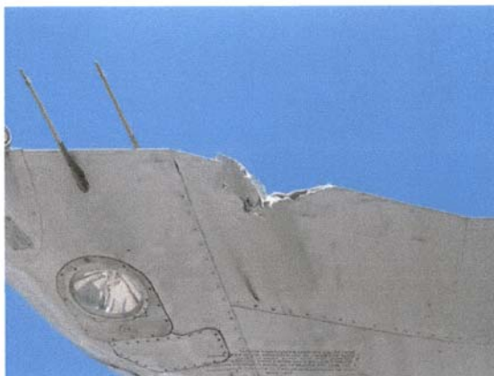
Danneggiamento della semiala sinistra del velivolo MD-80 marche I-DATM.
