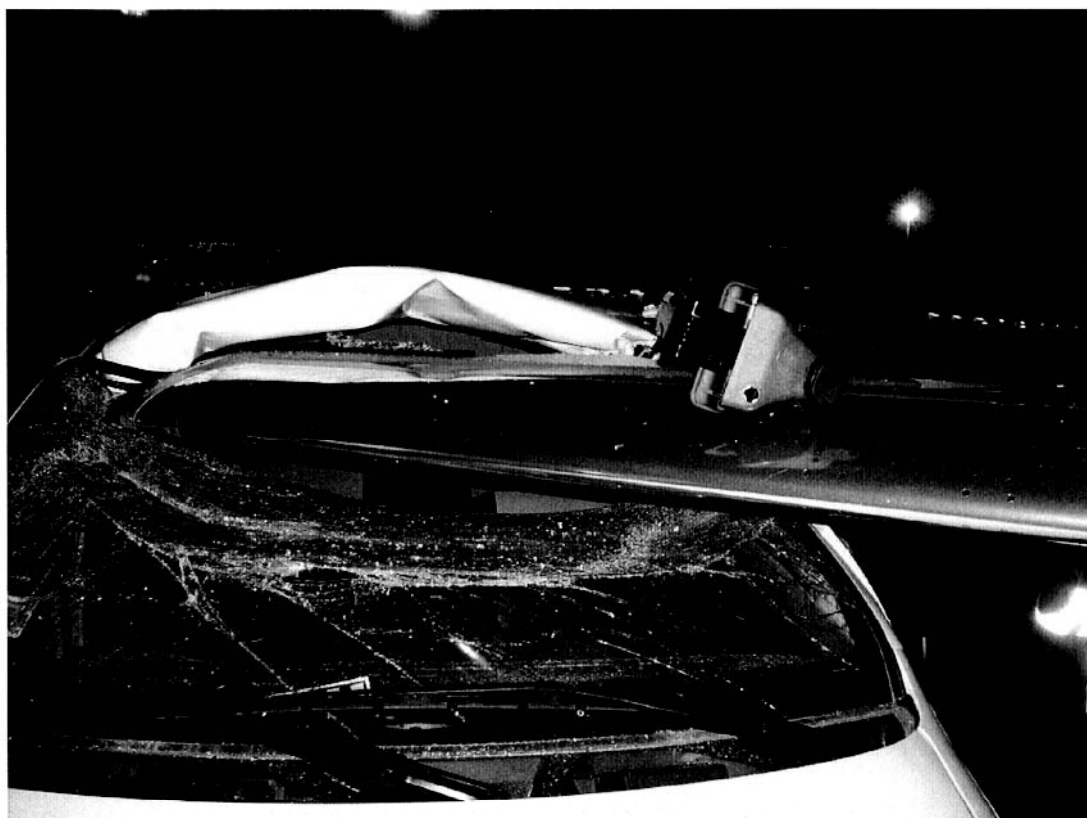
Danni provocati da un incidente di rampa.
