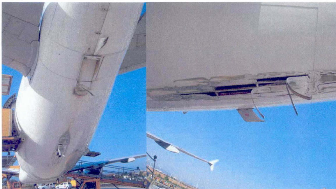
Aeromobile LZ-BHC: estesi danneggiamenti strutturali nella parte inferiore della fusoliera.
