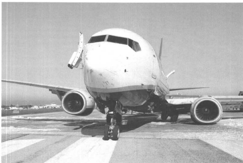
Birdstrike del 10.11.2008: notare le macchie rosse corrispondenti ad impatti con volatili .
