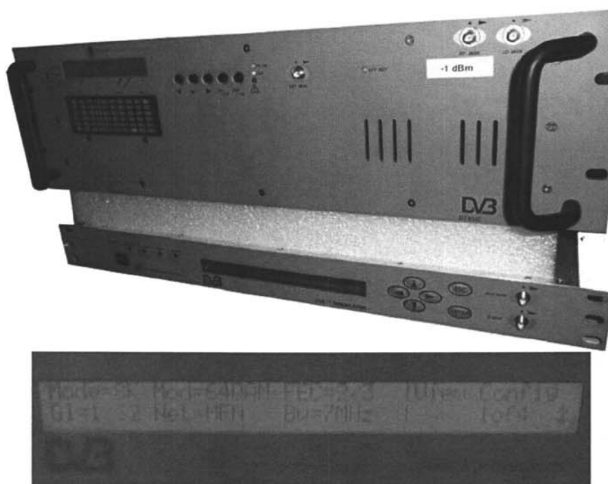
Figura 6.4: Sistema di trasmissione sul Ch 24 UHF e parametri di modulazione
