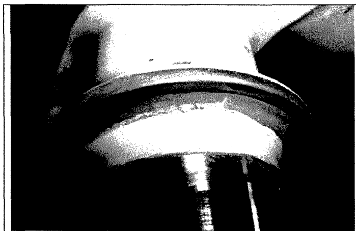
Photo n.1 – Corrosion signs on NLG axle
