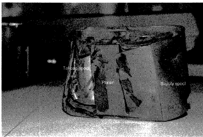
Banda metallica danneggiata.
