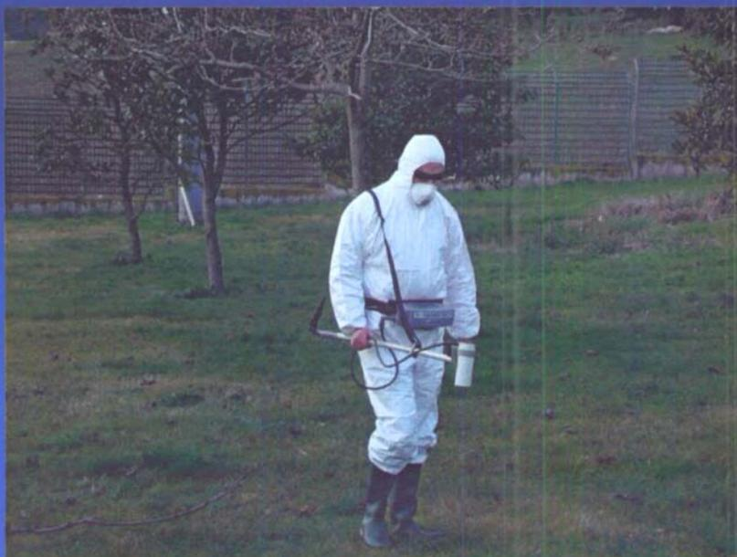
Le misure sono eseguite da un operatore in movimento sul terreno da investigare. Lo strumento, un magnetometro ai vapori di cesio (figura a lato), può acquisire con un passo di campionamento di 0.1 secondi. I dati raccolti vengono elaborati con opportuni software e il prodotto finale è una carta delle anomalie magnetiche dell'area, dove sono evidenziate le aree anomale rispetto ad un valore di fondo naturale.
