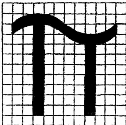
2. Il marchio Pi ha un'altezza minima di 5 mm. Per le attrezzature a pressione trasportabili con un diametro pari o inferiore a 140 mm l'altezza minima è 2,5 mm.
