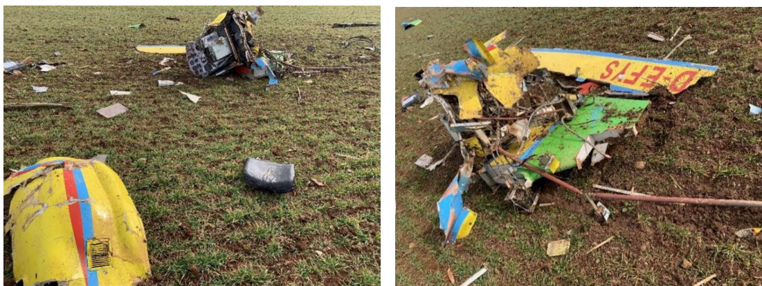
Parti del relitto del velivolo Mudry CAP 231 marche D-EFYS nel luogo dell'incidente.
