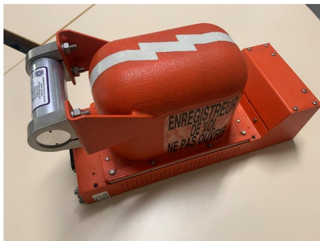
Recorder CVR che era presente a bordo dell'S64 marche I-CFAJ le cui tracce audio sono state acquisite presso i laboratori ANSV.
