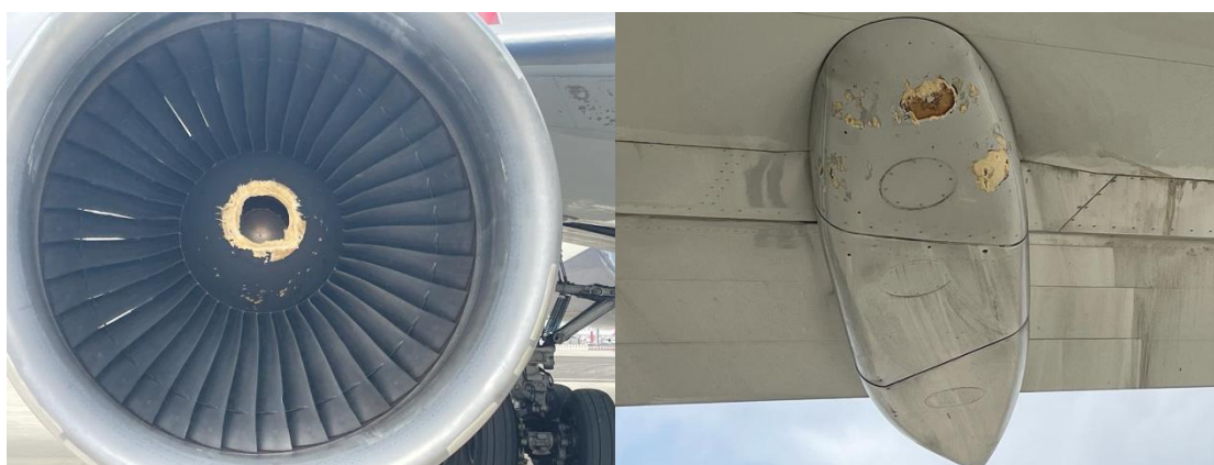
Altri danni causati dalla grandine.
