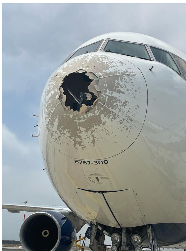
Danni causati dalla grandine.
