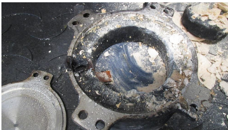
Attività di apertura recorder e recupero dati dal FDR e dal CVR danneggiati che era installati sul CL-415 marche I-DPCN. Nella foto l'apertura della CSMU 56 del CVR.
