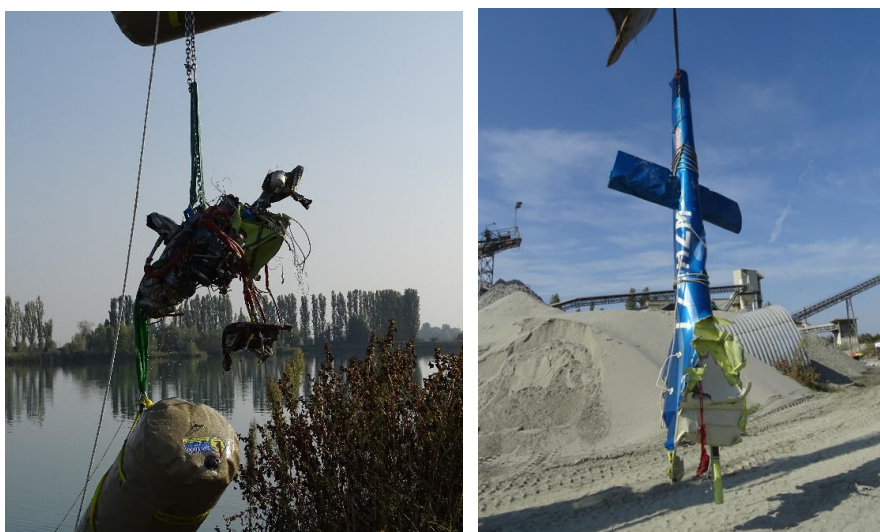
Il relitto dell’elicottero Bell 206B marche di identificazione T7-HZM durante il recupero nel luogo dell’incidente.
