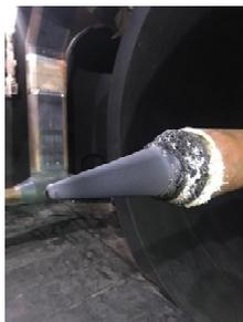
la preforma in scala reale di un nose di un veicolo per il rientro atmosferico, per dimostrare la capacità di manifattura di una geometria di grandi dimensioni e con superfici caratterizzate da ampi raggi di curvatura. Il componente è inoltre dotato di interfacce per l'integrazione con la struttura portante del veicolo.
