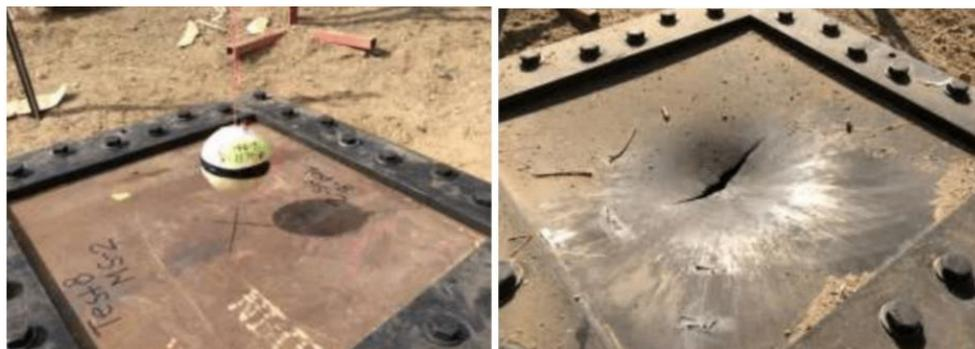
Immagine 7<sup>2</sup>: effetto di una carica di 1 kg di TNT equivalente posizionata a 11 cm da una lastra di acciaio dello spessore di 1 cm.
