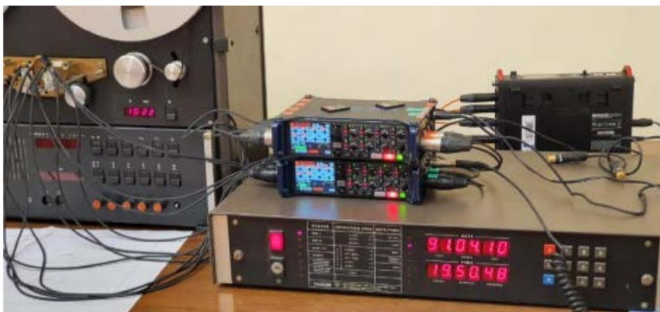
*Figura 7: Sistema di acquisizione digitale del nastro analogico originale registrato a Livorno radio nel 1991*
